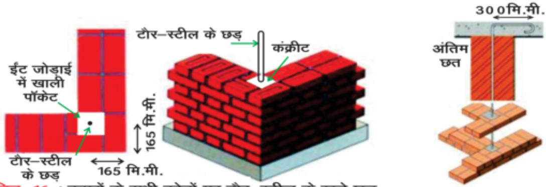
चित्र-16 : कमरों के सभी कोनों पर टॉर-स्टील के खड़े छड़
